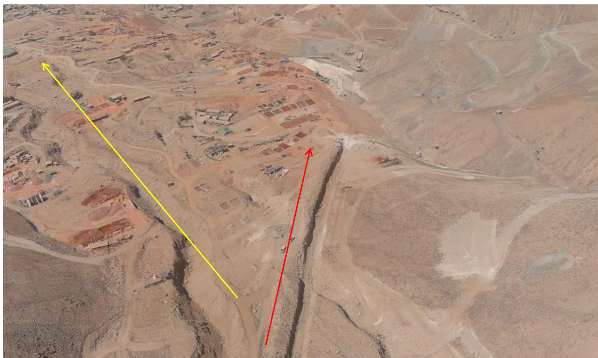
FIGURA N° 01: TRAMO CRÍTICO EN LA QUEBRADA SAN JUAN, SE VISUALIZA LA DESVIACION (COLOR ROJO) DE LA QUEBRADA QUE AFECTA EL CENTRO POBLADO RELAVE (QUEBRADA NATURAL SAN JUAN AMARILLO) CON DIRECCION AL PUEBLO.
